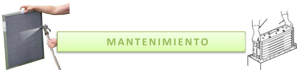
Los modelos de la gama **SK-3000 / SK-6000** son de fácil mantenimiento y limpieza. Para acceder al compartimento de los filtros posee una puerta con cerradura para sustituir los filtros. Para acceder a las células electrostática retirar la compuerta del módulo con una simple presión y extraerlas con precaución de no golpearla, pues están fabricadas con materiales muy delicados y láminas de aluminio muy finas.
